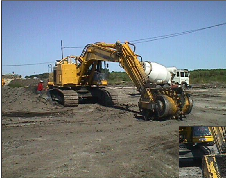
Retroexcavadora con rodillo de accionamiento hidráulico.
