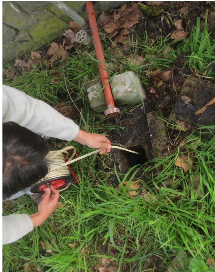
Figura 52: Medición del nivel estático utilizando la sonda piezométrica.
