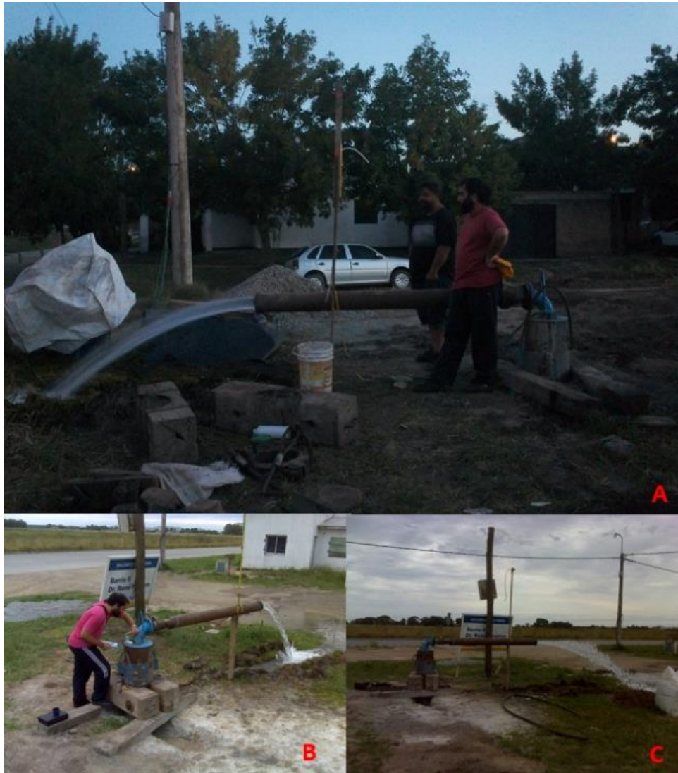
Figura 57. Ensayos de bombeo durante las campañas de este estudio en el pozo 15 (A) y en el pozo 14B (B y C).
