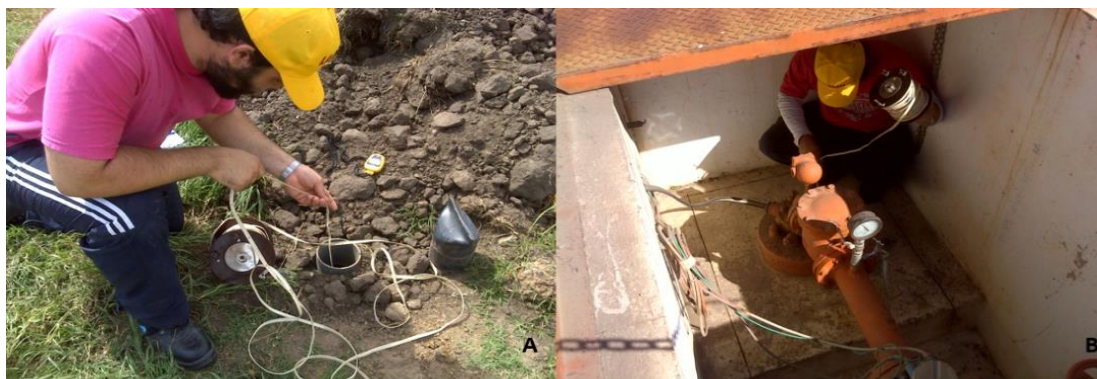
Figura 56. Mediciones con sonda piezométrica en piezómetros (A) y en pozos de bombeo (B).
