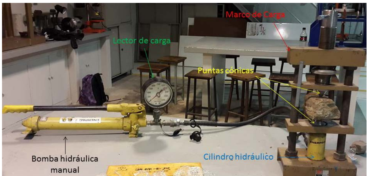
FIG. 9.40. Equipo utilizado para la realización del ensayo de carga puntual según norma ISRM, 1985. En la Universidad Tecnológica Nacional, Facultad Regional Buenos Aires (UTN FRBS).
