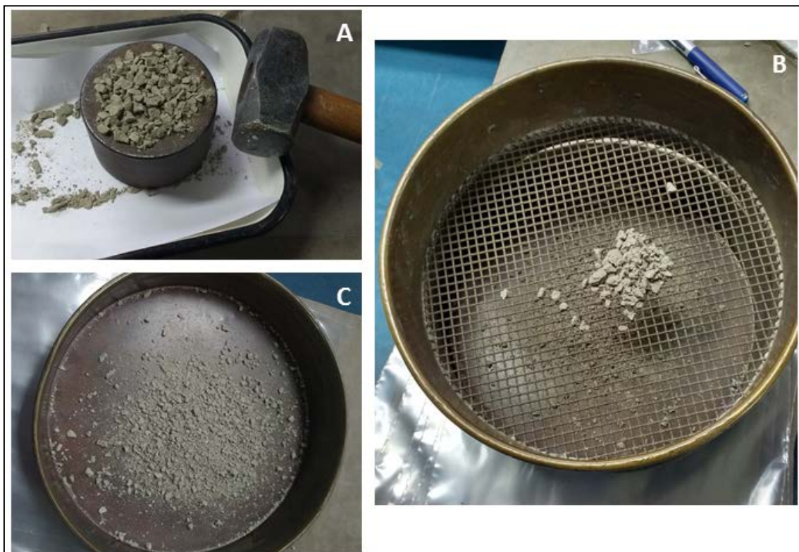
Fig. 9.30. A) Desagregación mecánica. B) Tamizado por tamiz ASTM N°4. C) Muestra con tamaño menor a 4,75mm.
