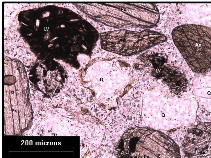
Figura 4.15: Corte petrográfico de la muestra PB-1 (duna inactiva), donde se observan líticos volcánicos (LV), Anfíboles (An), Cuarzo (Q) y piroxenos (Px)
