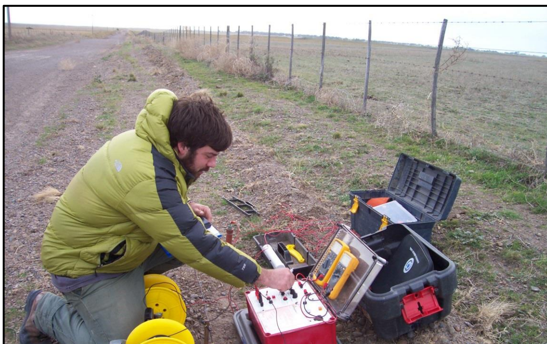
Figura 5.2: Dispositivo de medición utilizado durante la campaña de geoelectrónica.
